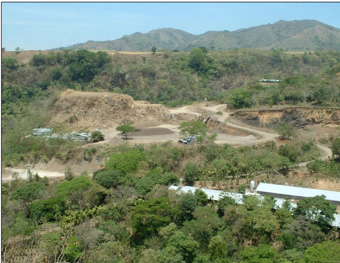
**Imagen 3.3 Tajo de explotación de tobas e ignimbritas sanas. De esas rocas se obtiene arena, lastre y materiales para la construcción.**
